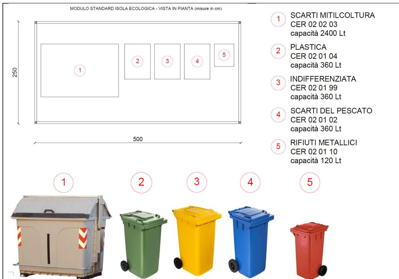
Figura 3: Vista in pianta modulo standard "Isola Ecologica" e disposizione cassonetti di raccolta.
